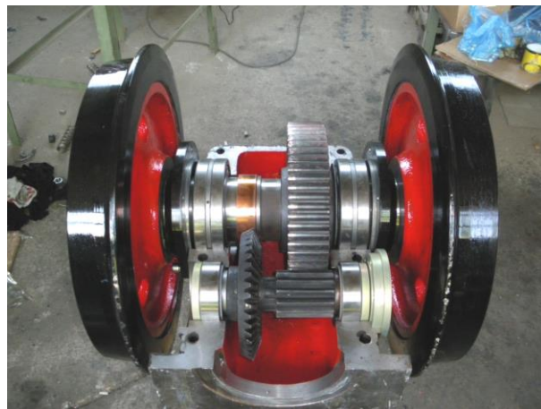
Фиг. 10. Редуктор K10
