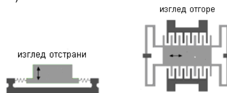
Фиг. 6. Принцип на действие на електростатичните микрогенератори
