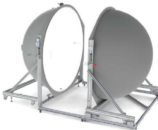
Фиг. 1. Общ изглед на кълбовия фотометър
