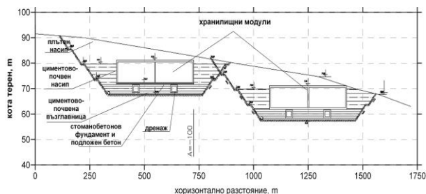
Фиг. 3. Вертикален разрез на хранилищните модули
