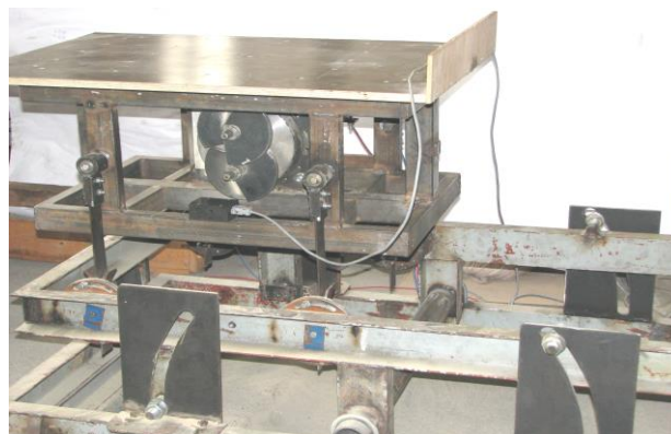
Фиг.6. Измерване на ускорения по ОК z.
