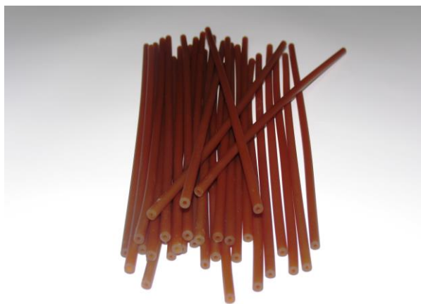
Фиг.1. Едноканален нитроглицеринов барут с трудно летлив разтворител с марка НДТ-3 18/1 от ненужни боеприпаси
