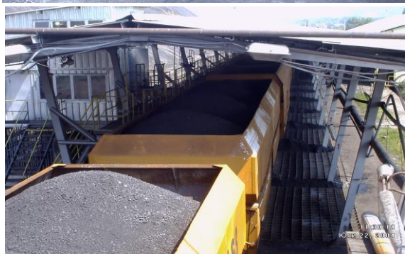
Фиг. 3. Разтоварване на вагоните с въглища на приемния бункер над галерията
