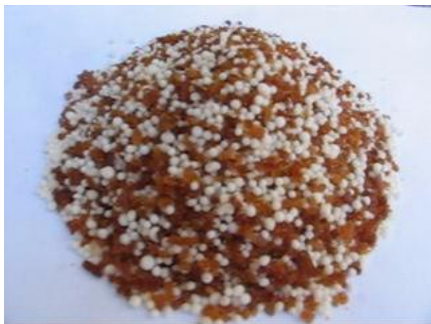
Фиг.5 Общ вид на новия грубодисперсен експлозив сенсibiliзиран с вторичен бездимен барут с марка ГДА -БМ
