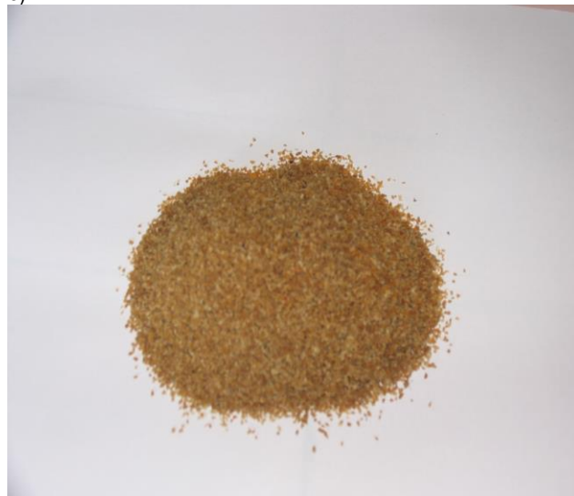
Фиг.4 Смлян нитроглицеринов вторичен барут: а-с едрина 2 mm; б – с едрина 1 mm
