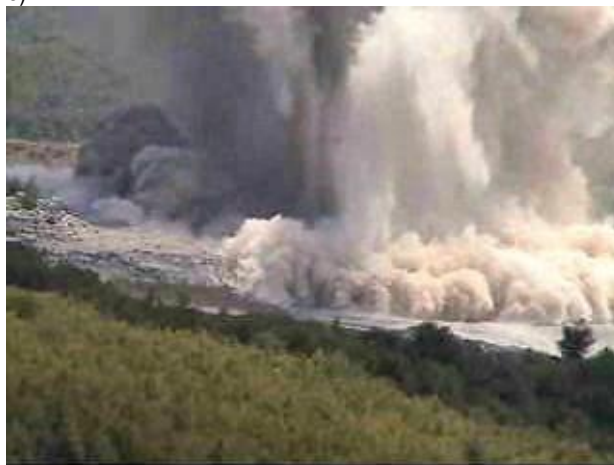
Фиг.8 Вид на взривното поле на кариера „Нановица“: а – преди взривяването; б – след взривяването, в дясно газопрахов облак от експлозива ГДА-БМ, а в ляво от експлозива ГДА - ЛМ
