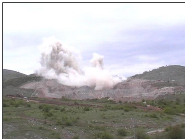
Фиг.3. Визуален ефект на газопраховите облаци при взривяване на ВВ АНФО - Л с нулев КБ в лявия участък и с минус 7 % КБ в десния участък в кариера "Студена"
