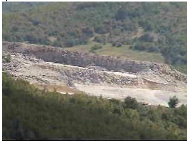
Фиг.9 Общ вид на разрушения материал: а- от частта на полето с експлозива ГДА-БМ; б- от частта на полето с експлозива ГДА-ЛМ
