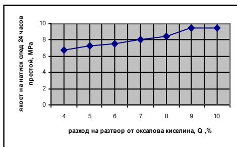
Фиг. 6. Зависимост между количеството оксалова киселина (под формата на 10,0% воден разтвор) и якостта на натиск на брикети изследвана след 24 часов престой при температура 15°C и постоянен разход на талов пек 6,0%
