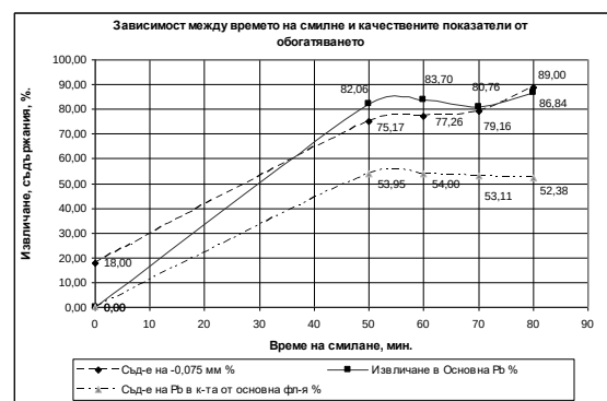
Фиг. 7. Влияние на степента на смилане върху показателите от флотацията на рудата „Аладаг“
