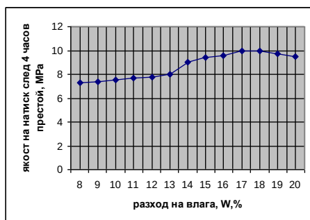
Фиг. 3. Зависимост между процентното съдържание на влага и якостта на натиск на брикети изследвана след 4 часов престой на брикетите при температура 18°C и постоянен разход на свързващо вещество "Emcol-K" 2,0%
