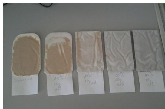
Фигура IV.21. Залепване на гипсови тела и хартия, преди сушене с нарастващо процентно съдържание на пепелина в състава на матрицата, 15 ÷ 45%
