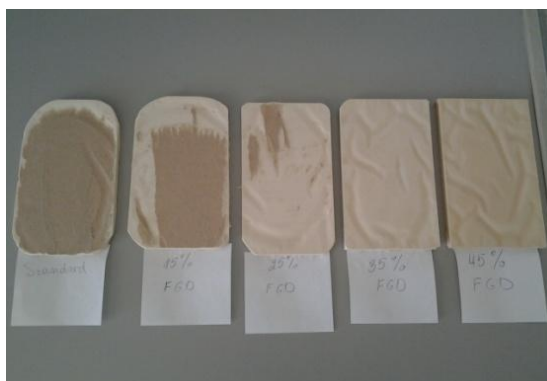
Фигура IV.41. Залепване на гипсови тела и хартия, преди сушене с нарастващо съдържание на десулфодихидрат в състава на матрицата, (15 ÷ 45%)
