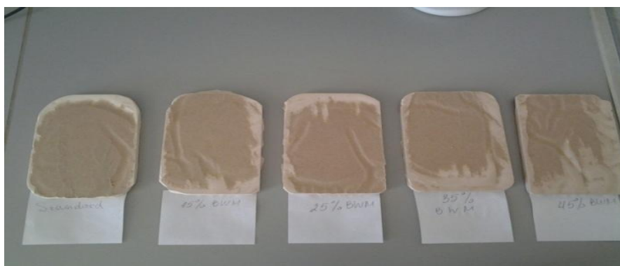
Фигура IV.15. Залепване на гипсови тела и хартия, преди сушене с нарастващо процентно съдържание на строителни отпадъци в състава на матрицата, 15 ÷ 45%
