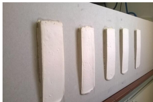
Фигура IV.27. Изследване на образуването на пукнатини. Гипсови тела със съдържание на каолин 15 \div 45\% в състава
