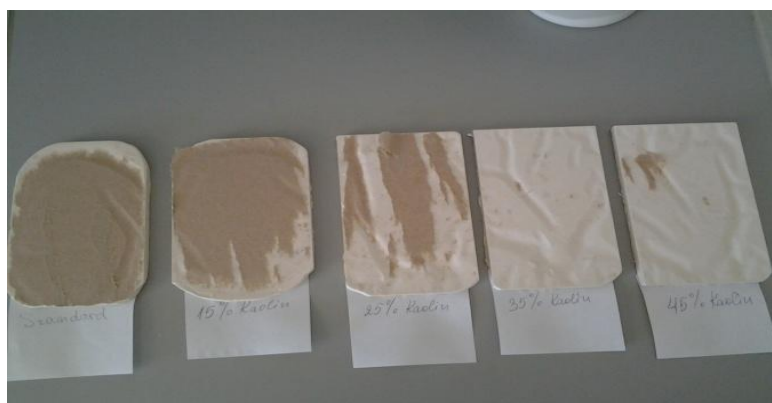
Фигура IV.28. Залепване на гипсови тела и хартия, преди сушене с нарастващо съдържание на каолин в състава на матрицата, 15 \div 45\%
