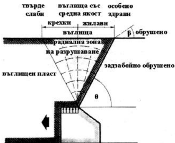
фиг.3.2. Схема на зоната на разрушаване като функция от якостта на въглищата
