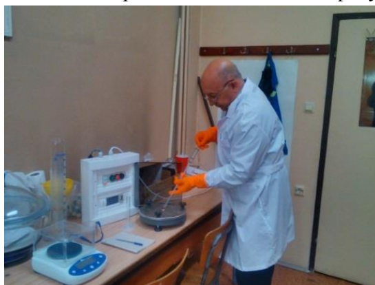
Фиг.9. Измерване на CST
