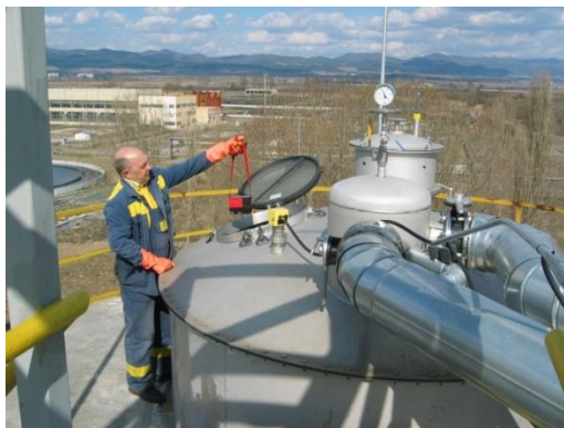
Фиг.6. Ръчно измерване на качествения състав на биогаза
