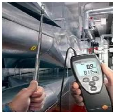
Фиг. 7. Термоанемометрично измерване на дебита на биогаза
