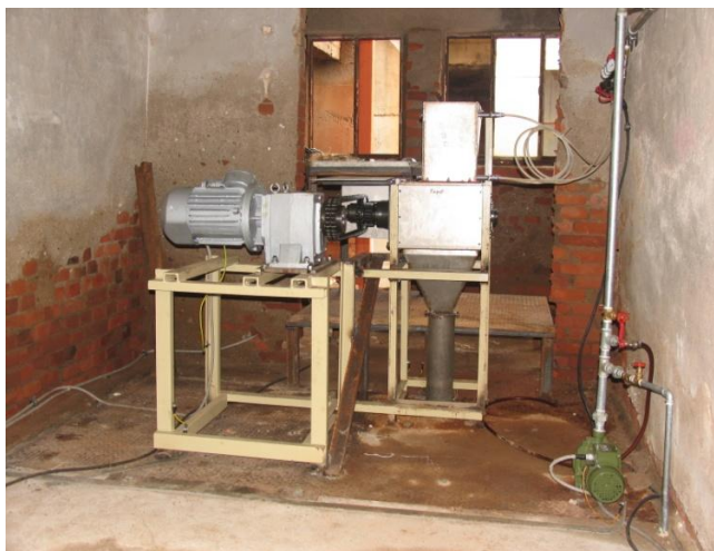
Фиг.2.6. Общ вид на мелницата за оситняване на вторични бездимни барути
