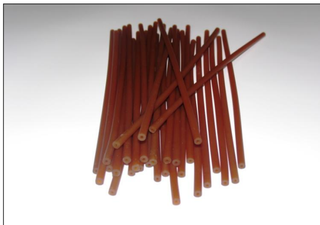
Фиг. 2.4. Общ вид на едноканалния нитроглицеринов барут с трудно летлив разтворител с добавка на динитротолуол с марка НДТ-3 18/1 получен от ненужни боприпаси.
