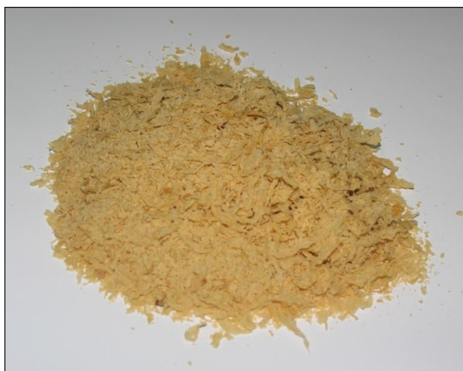
Фиг.2.5. Общ вид на нитроглицериновия барут с марка НДТ-3 18/1 допълнително оситнен за поставяне във водонапълнени експлозиви.
