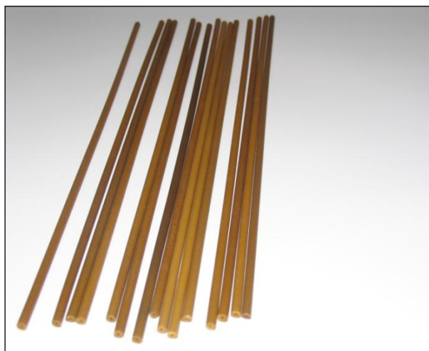
Фиг. 2.3. Общ вид на едноканалния пироксилинов барут с летлив разтворител с марка 18/1 тр получен от ненужни боеприпаси.
