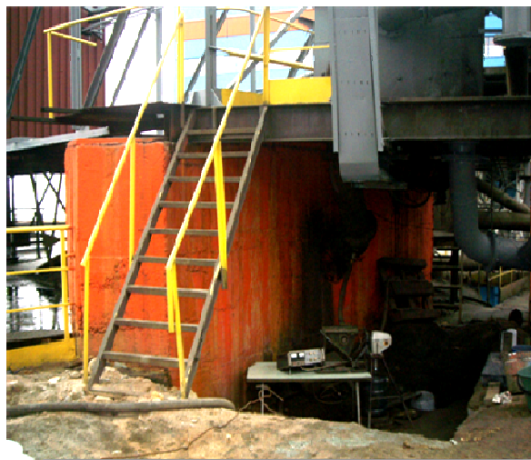
Фиг. 30. Инсталация за разрушаване на флотационна пяна в непрекъснат цикъл 1 - захранващата тръба на сгъстителя, 2 - байпас с кран, 3 - токоизправител, 4- вибрационен апарат, 5 - механична бъркалка
