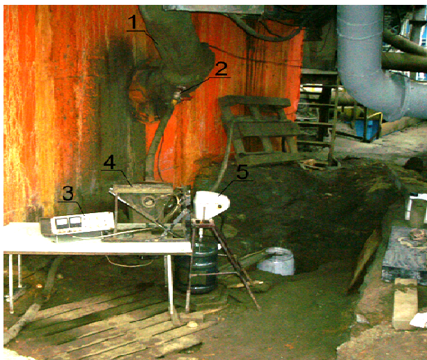
Фиг. 30. Инсталация за разрушаване на флотационна пяна в непрекъснат цикъл 1 - захранващата тръба на сгъстителя, 2 - байпас с кран, 3 - токоизправител, 4- вибрационен апарат, 5 - механична бъркалка
