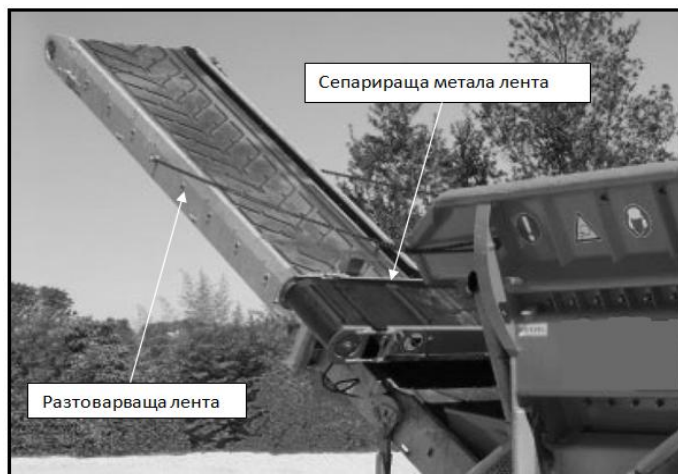
Фиг. V.5. Лента за сепариране на метални частици
