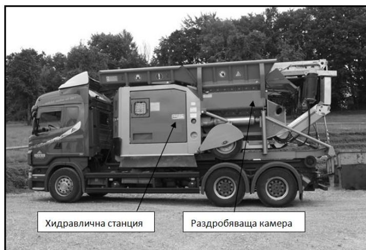
Фиг. V.8. Хидравлична станция
