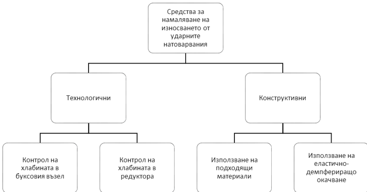
Фигура 43. Методи за намаляване на износването от ударните натоварвания
