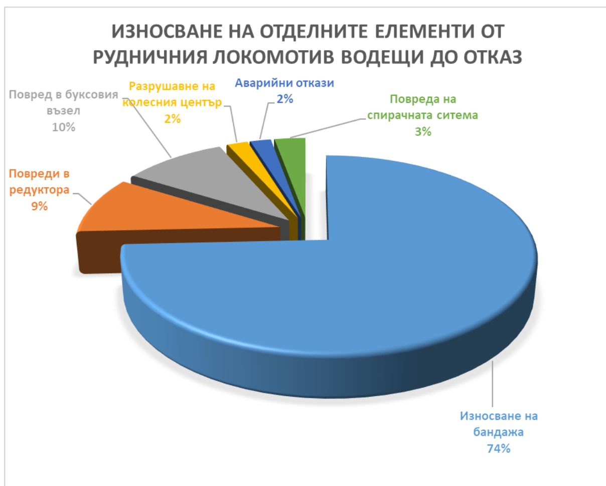
Фигура 45. Износвания, водещи до отказ
