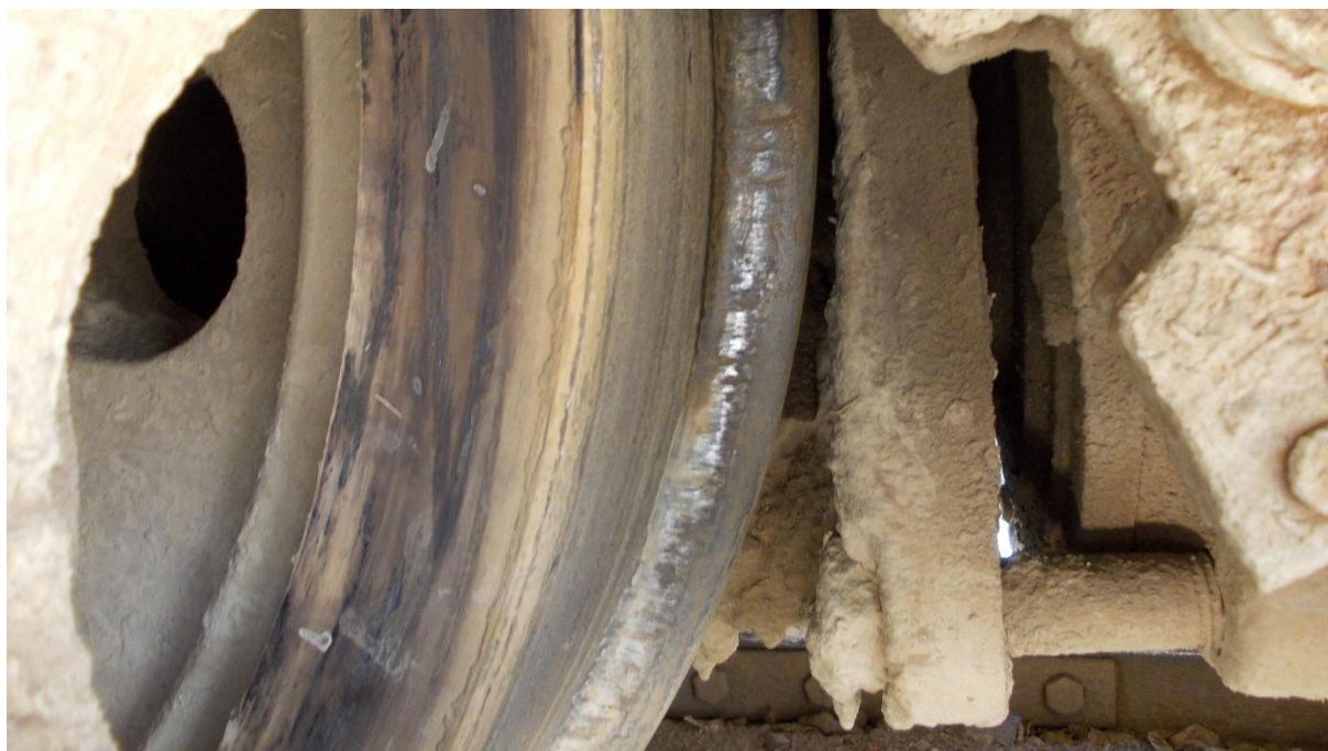
Фигура 59. Износване на реборда със задиране
