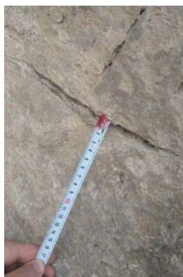
Фигура 9.14: Измерване на ширината на пукнатина 5 с ролетка (измерена ширина е 1cm)
