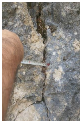
Фигура 9.17: Измерване на ширината на пукнатина 6 с ролетка (измерена ширина е 4cm)
