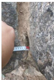
Фигура 9.2: Измерване на ширината на пукнатина 1 с ролетка (измерена ширина е 3cm)
