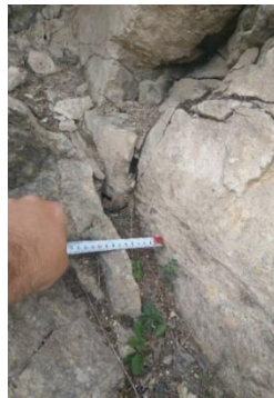
Фигура 9.5: Измерване на ширината на пукнатина 2 с ролетка (измерена ширина е 6cm)
