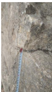
Фигура 9.11: Измерване на ширината на пукнатина 4 с ролетка (измерена ширина е 1cm)
