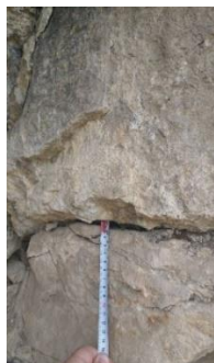
Фигура 9.8: Измерване на ширината на пукнатина 3 с ролетка (измерена ширина е 1cm)
