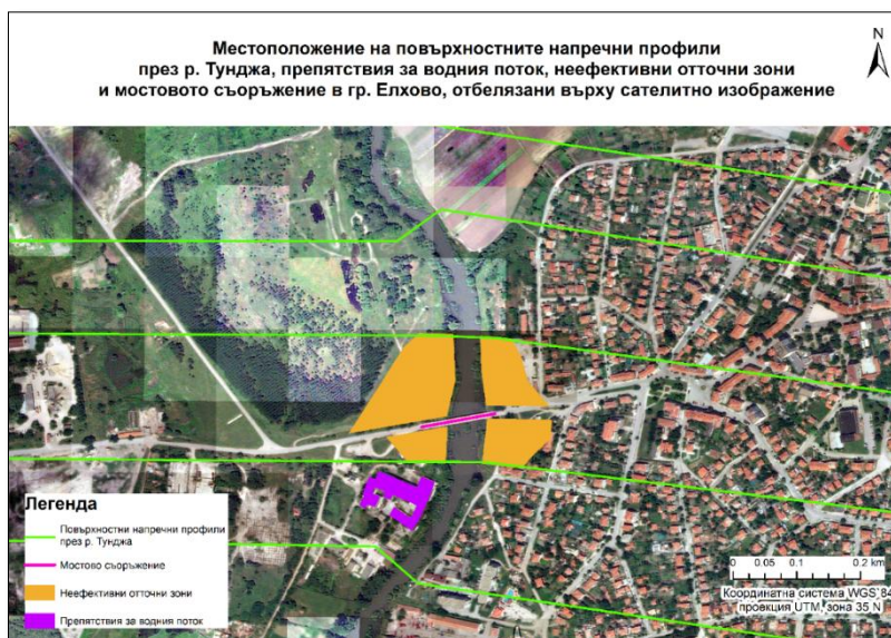
Фиг. 4.3.2.1.2. Създаване на повърхностните напречни профилни сечения, мостовото съоръжение, неефективните отточни зони и препятствия за водния поток, карта на земеползването
