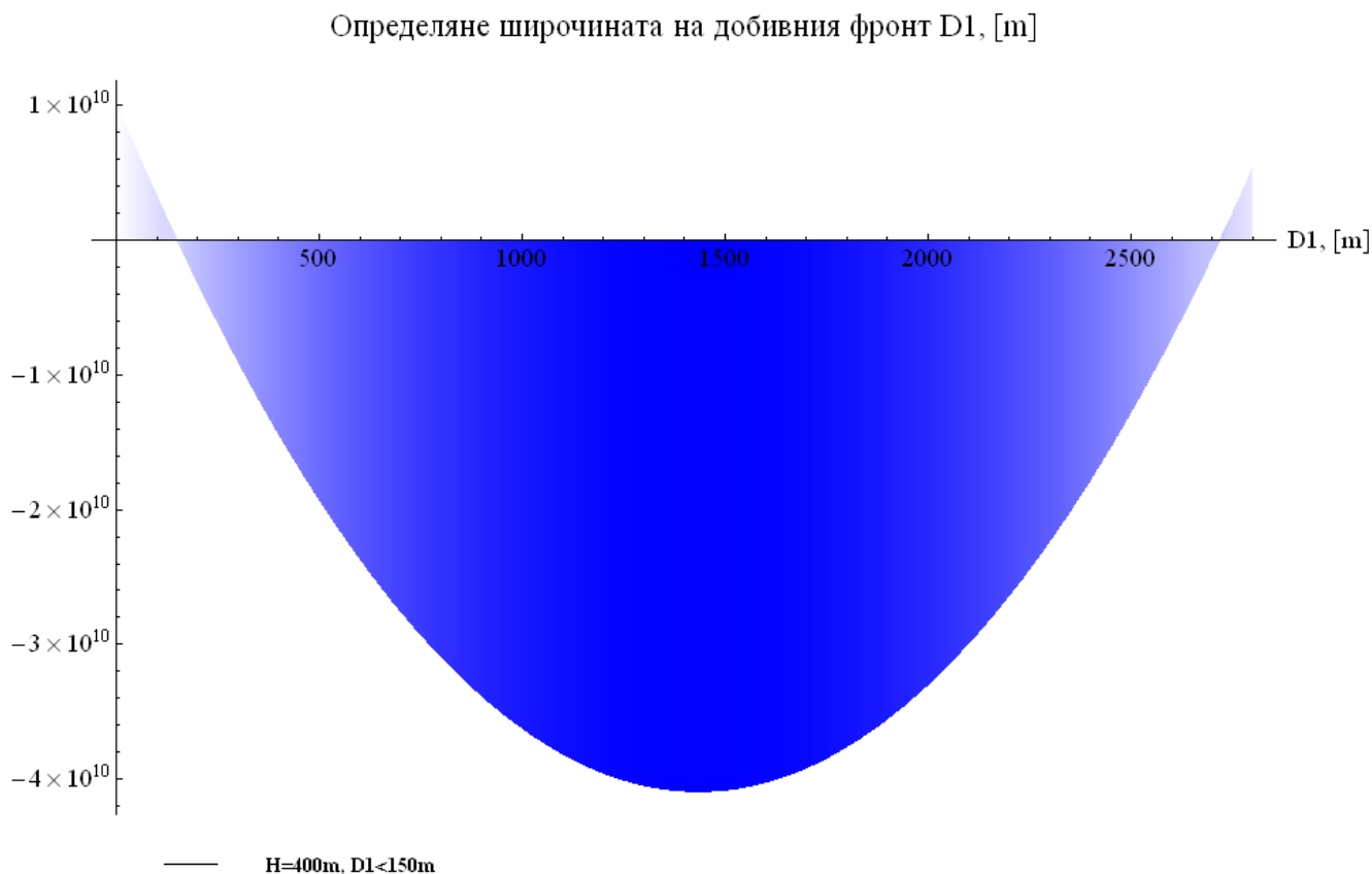
Фиг. III.6 Графично решение на квадратно неравенство (III.26), при H=400 m и m=5 m.
