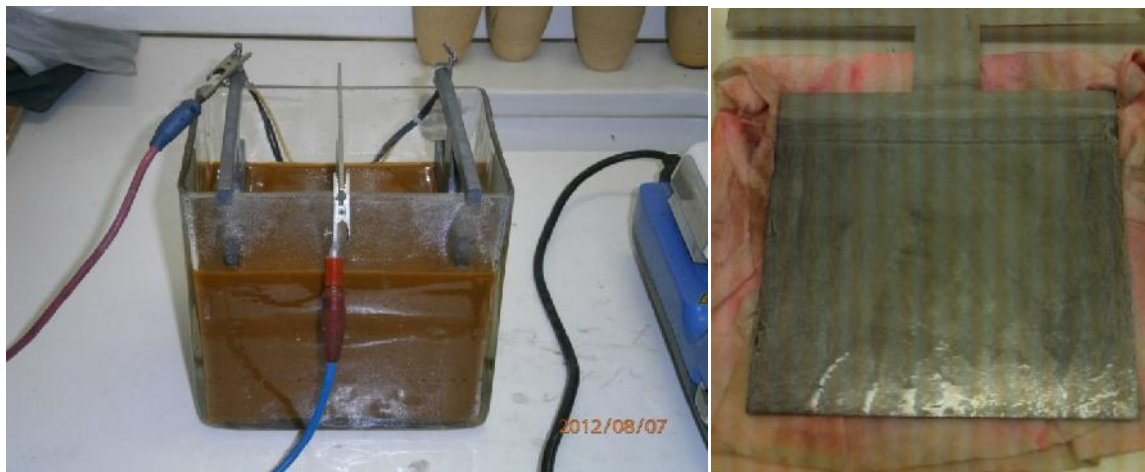
Фиг 23. Лабораторна установка за електролиза на желязо от феросулфат.
