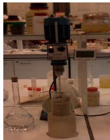
Фиг.19 Съд за излужване с бъркалка
