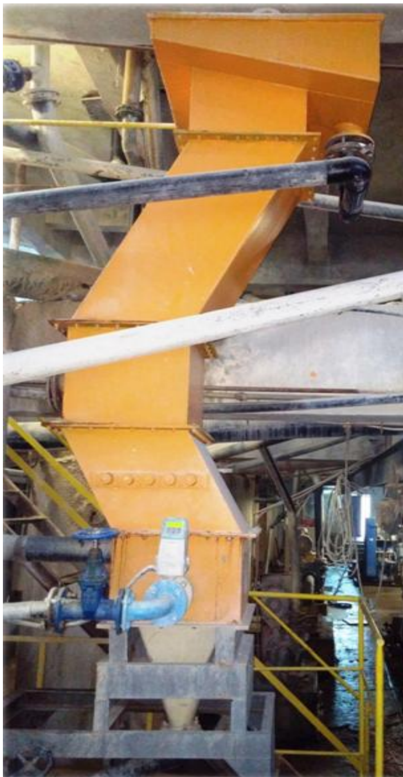
Фиг. П. 14. Промислен прототип ламелен рефлукс класификатор
