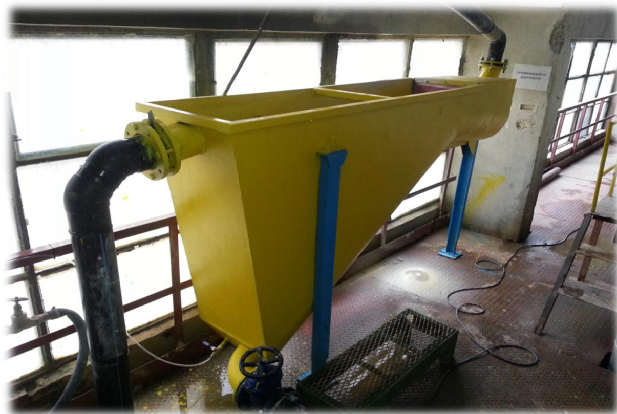
Фиг. II.9. Промислен прототип аеролифтен класификатор
