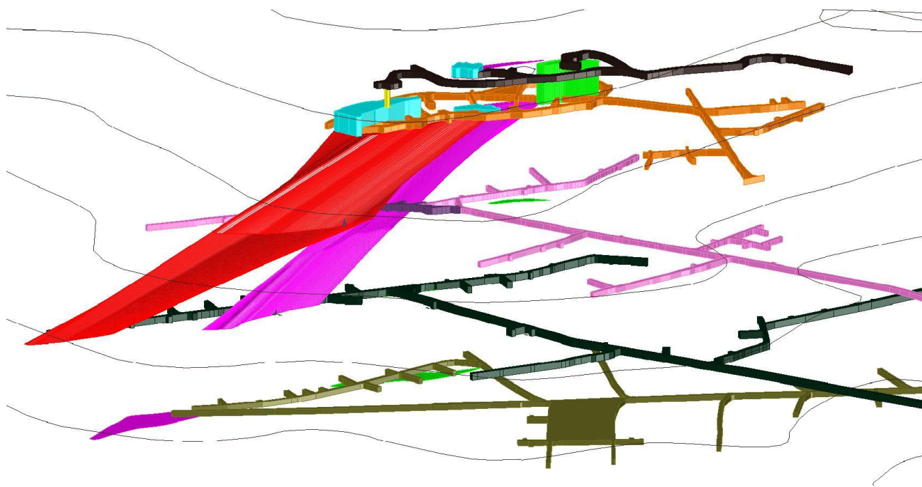
Фиг.9. Цифров тримерен модел на рудник Лукина падина.
