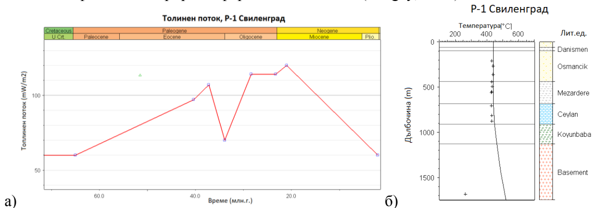
Фиг. 27. Модел на палеотоплинния поток за сондаж P-1 Свиленград (а), калибриран с моделираните от софтуера стойности на зрелостта с тези получени при пиролиза (б)
