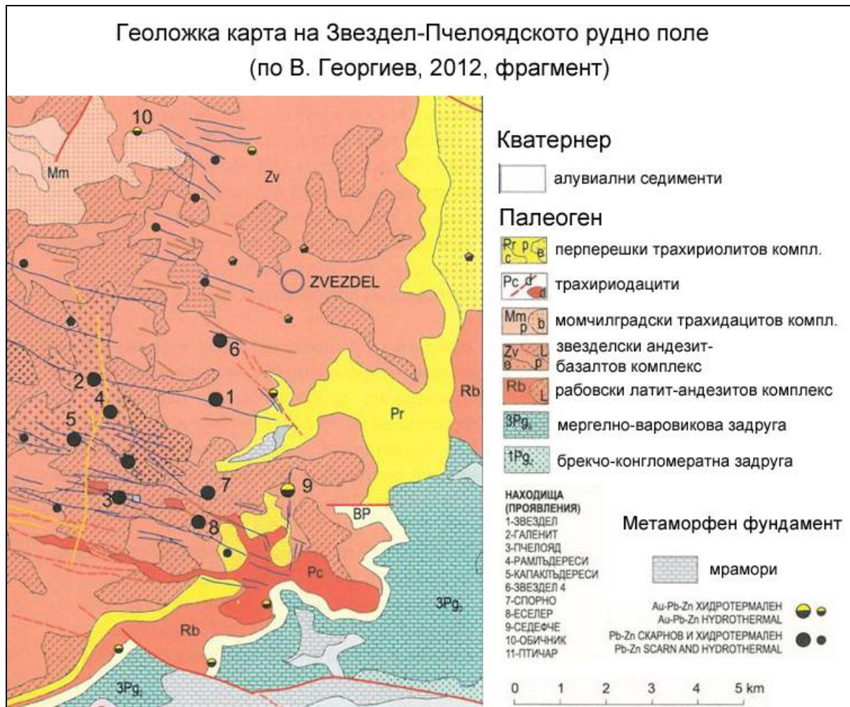
Фиг. I.5.1. Металогенна карта на Звездел-Пчелоядското рудно поле (Георгиев, 2012). Находище Седефче е отбелязано с № 9.
