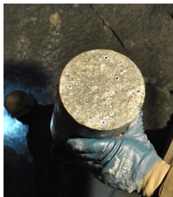
Фиг. 23. Фотосесия на основните етапи на експеримента по метода на пълното разтоварване на открити повърхности
