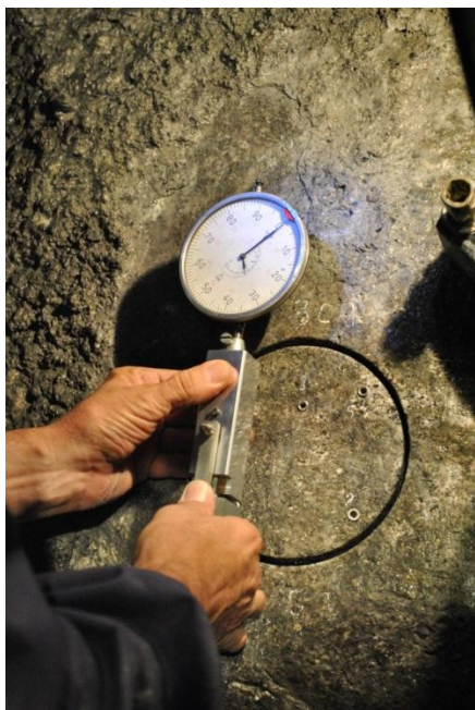
Фиг. 23. Фотосесия на основните етапи на експеримента по метода на пълното разтоварване на открити повърхности
