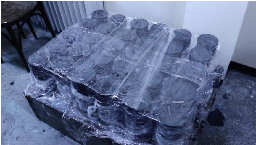
Фигура 4 - Пробни тела от направеният замес в лабораторията на МГУ „Св. Иван Рилски“
