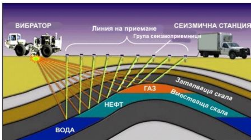
Фиг. 1. Типично разположение на нефтогазоносните залежи в антиклинални структури
