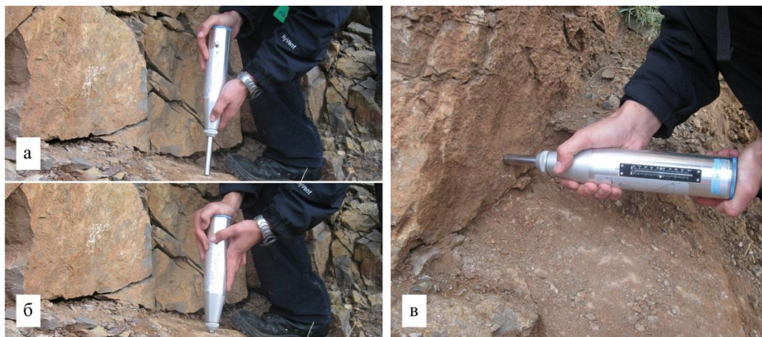
Фиг. 5-5. Методика на теренно определяне на стойностите на якостта на масива с помощта на чук на Schmidt: (а) подготовка за измерване и (б) фиксиране на отчета на скалата при вертикална и (в) хоризонтална ориентация на инструмента.
