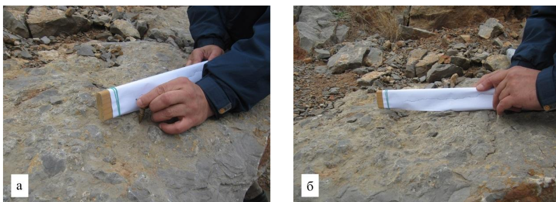
Фиг. 5-4. Заснемане на грапавостта на стените на пукнатинните повърхности с помощта на милиметрова хартия и показалец: (а)
