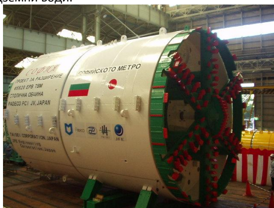
Фиг. 3. Използваната тунелно пробивна машина (сглобена в завода на производителя) [3]
