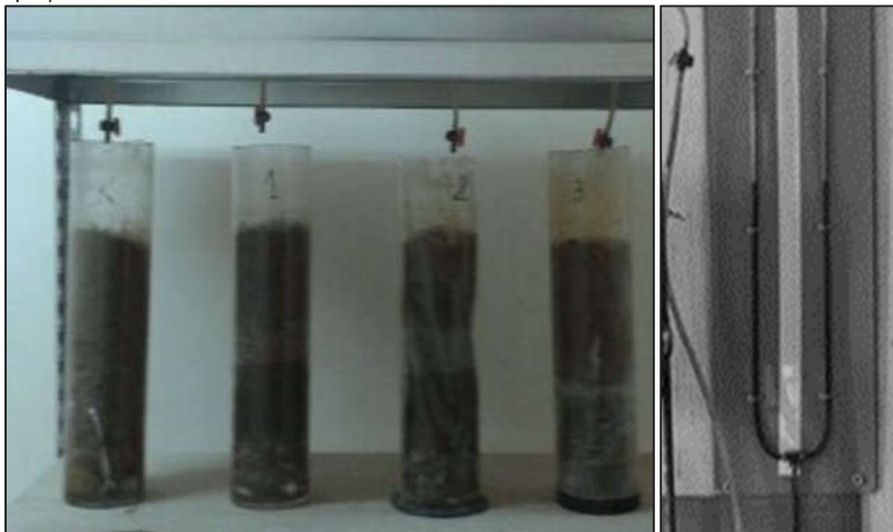
Фигура 14. Снимки на опитната инсталация с U-образен диференциален манометър и на филтрационните колони
