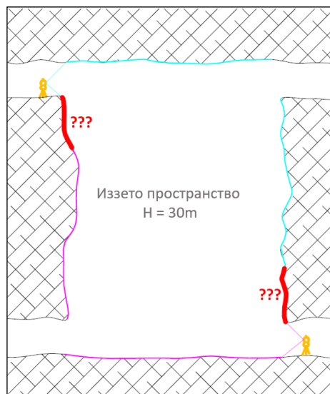
Фиг. II.3.11 Схема за заснемане на добивно пространство с двустранен достъп.
