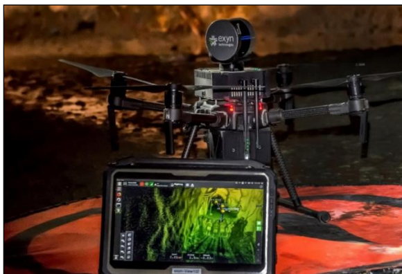
Фиг. II.3.34 Автономен сканиращ дрон Eхun Technologies и таблет за визуализация
