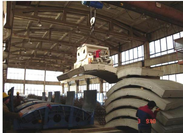
Фиг. 4. Декофриране на сегмент с механична лапа
