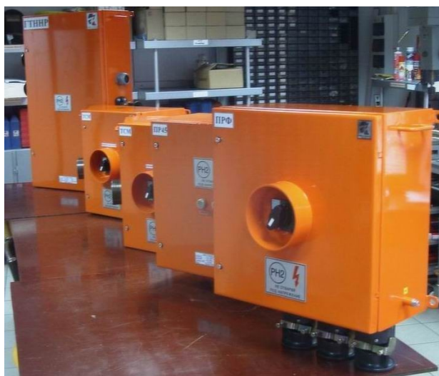
Фиг. 8. Пускатели ПР и разпределително табла ГТНР в руднично нормално изпълнение
