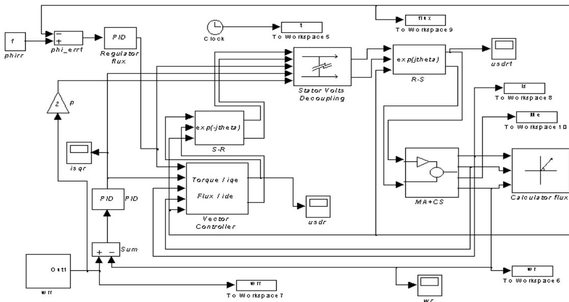
Schema de simulare cu orientare dupa fluxul rotoric
