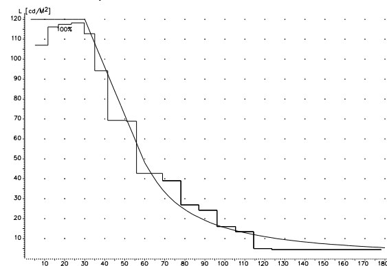
фиг.5. Разпределение на яркостта във входната и преходната зона на тунела.
