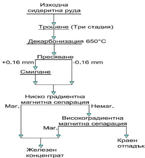
Фиг. 1. Технологична схема на опитите с термична преработка на рудата
