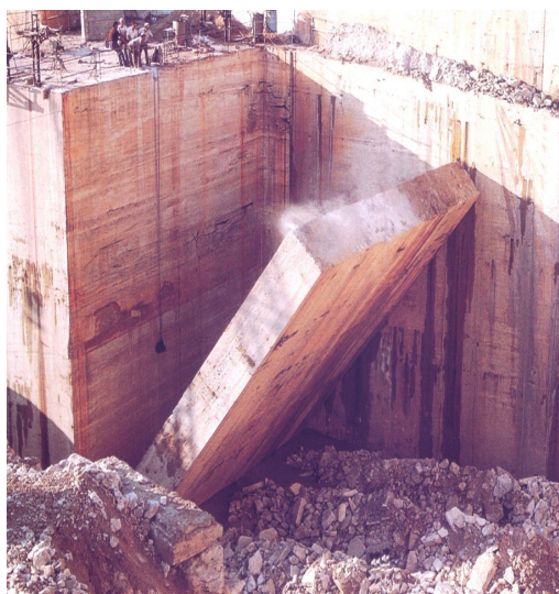
Фиг.1. Отделяне на добит блок от скалния масив
