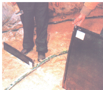
Фиг.6. Технологична схема на отделяне на блокове от скалния масив с метални водни "възглавници"
