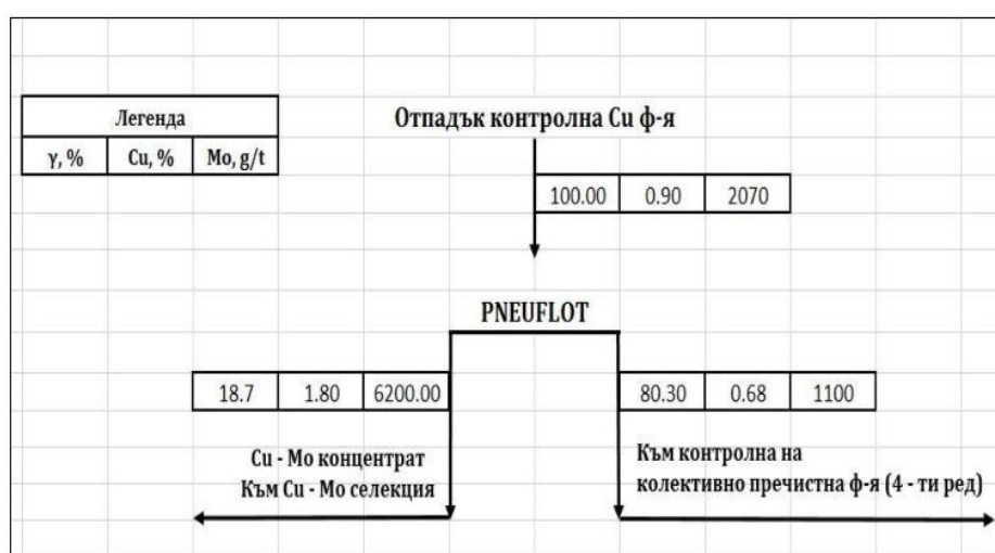
Фигура V.60. Схема на флотация на отпадък от контролна медна флотация с флотационна машина Pneufлот
