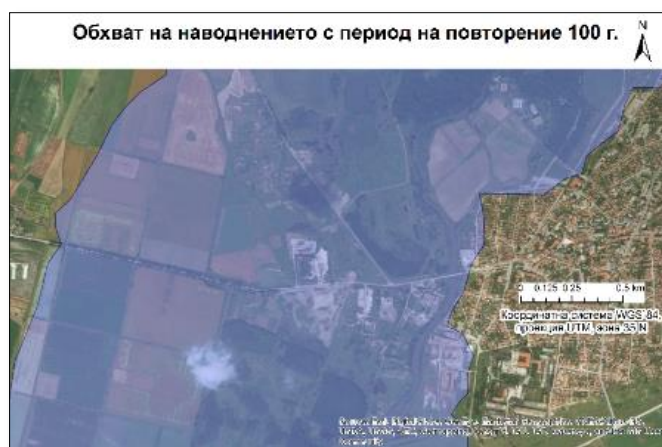
Фиг. 4.4.1. Фрагмент от картата на обхвата на наводнението с период на повторение 100 г., представяща разпространението на водния поток при шосето между гр. Елхово и с. Изгрев, и околните територии
