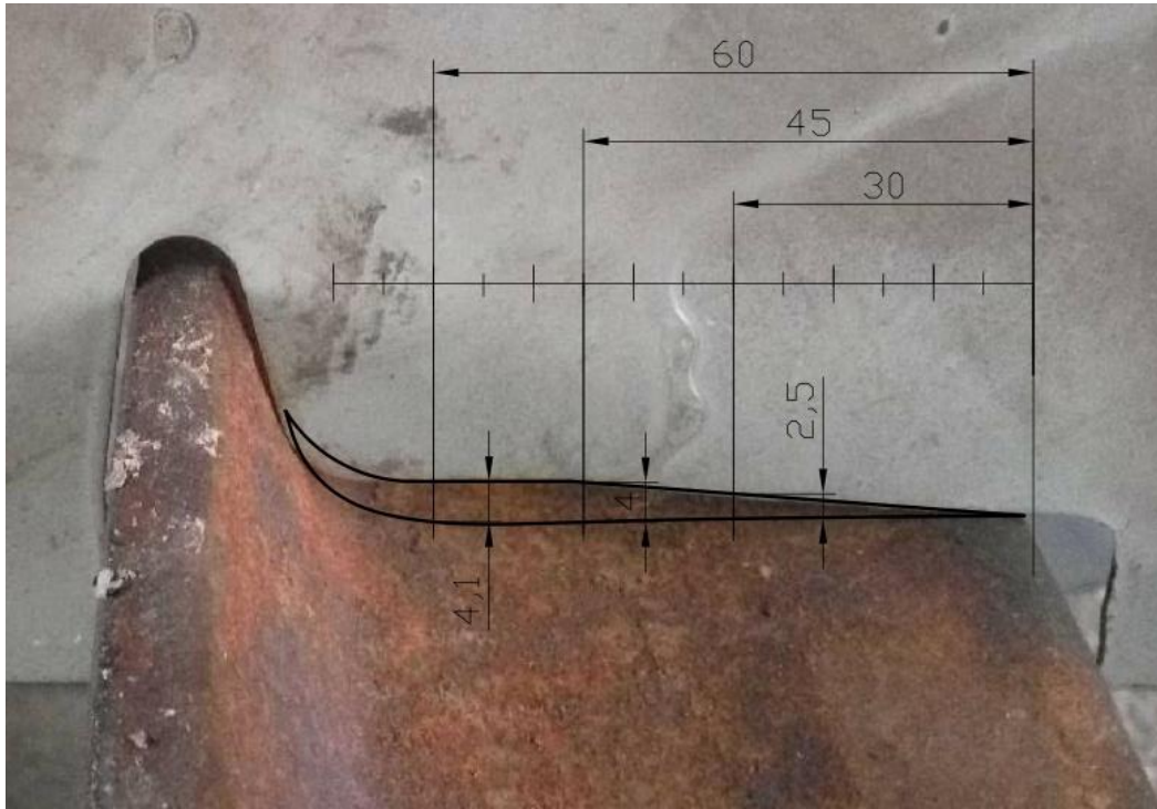
Фигура 20. Износване на бандаж Стомана 101
