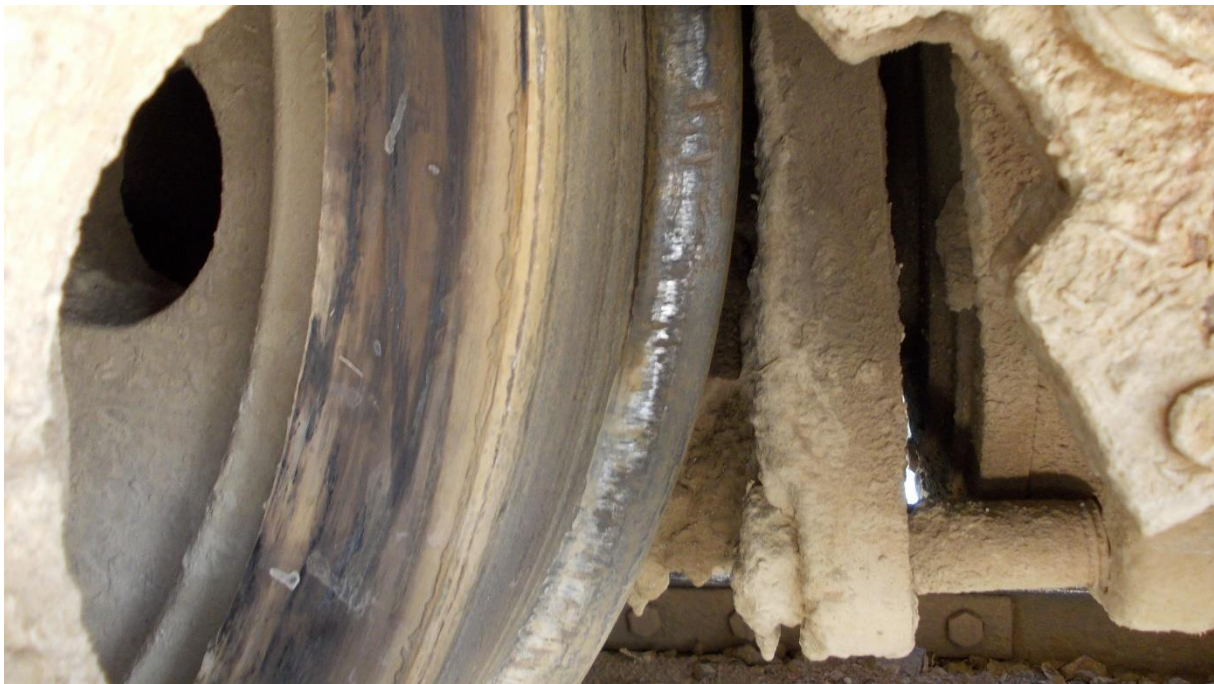
Фигура 25. Износване на реборда със задиране
