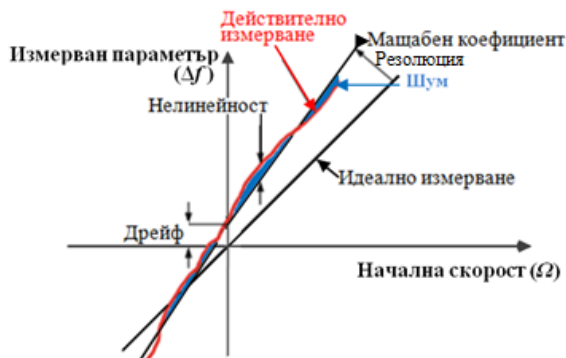
Фигура 1. Параметри на грешките, обуславящи разликата между идеално и действително измерване
