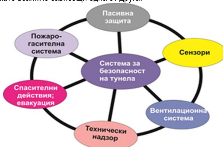
Фигура 6. Интегрирана (свързана) система за безопасност на тунел
