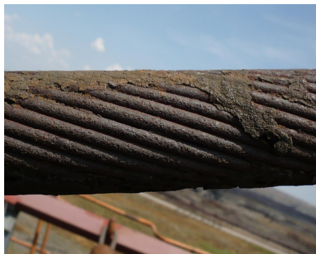
Фиг. 3. Част от корозирало опъвателно въже.
