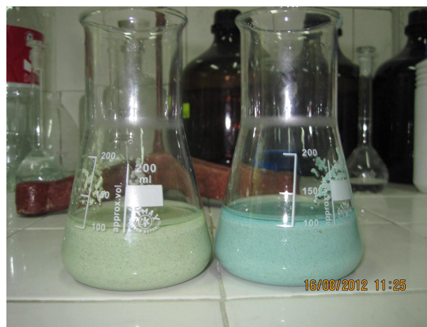
Фиг. 2. Смола, набогатена с мед и тривалентно желязо (вляво) и само с мед (вдясно)
