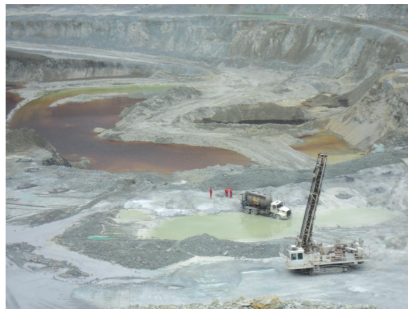
Фиг. 1. Извършване на ПВР в открит рудник
