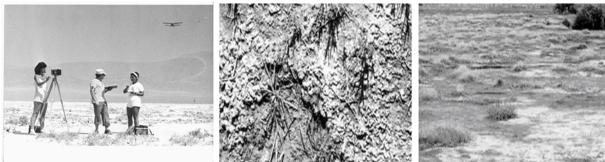
Фиг. 2. Наземно и самолетно спектрометриране на засолен почви в района на езерото Аджиноур, Азербайджан
