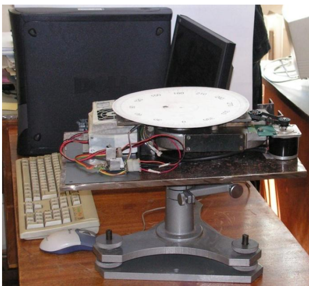
Фиг. 11а. Стойка на гониофотометъра с махнат капак.
