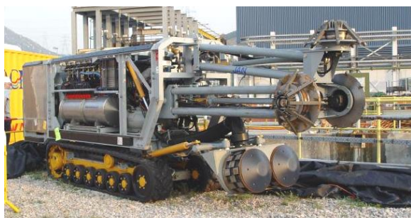
Фиг.2. Земснаряд за подводен добив на ПИ от морското дъно
