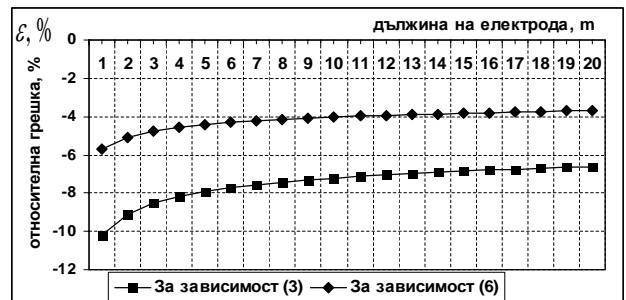
Фиг. 5. Относителна грешка в проценти на изведените зависимости за определяне съпротивлението на конвенционален вертикален заземител при изменение на дължината на електрода l
