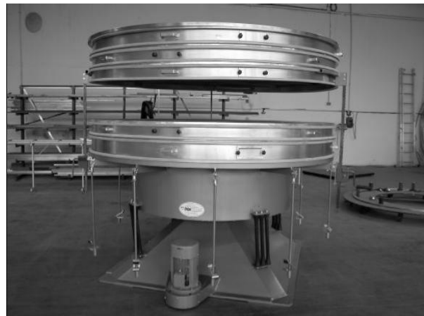
Фиг. 2. Трипалулна вибрационна пресевна машина KTS 2000/3.
