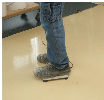
Фиг. 2. Измерване на електрическото съпротивление съгласно БДС EN 1081
