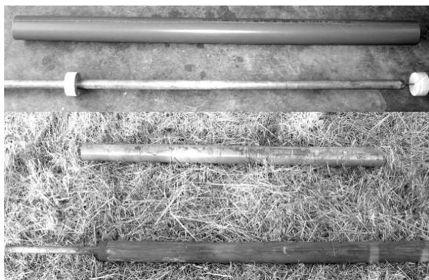
П. 3. Приспособления за отливане на първия слой проводим бетон при вертикален заземител с двуслойна обmazка.
