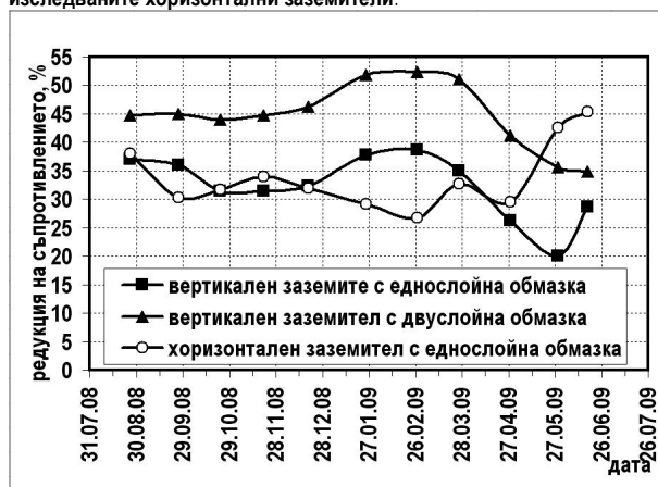
Фиг. 2.3. Редуция в проценти на съпротивлението на заземяване за различните видове заземители с проводима бетонна обмазка спрямо конвенционалните.
