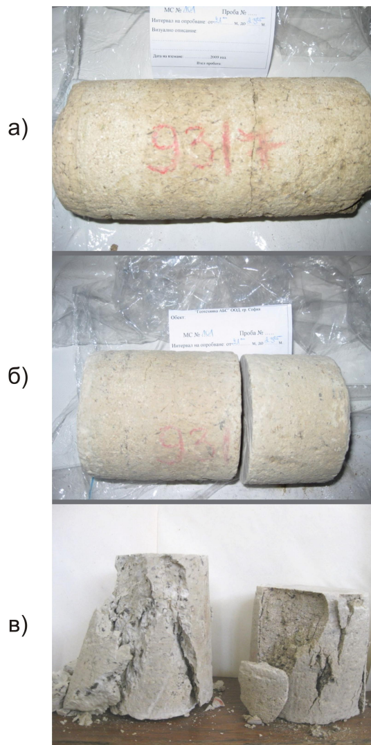
Фиг. 1. а) фрагментиране на пробното тяло след разопаковане; б) изрязани образци с полуправилна форма; в) образците, след изпитване на едноосов натиск
