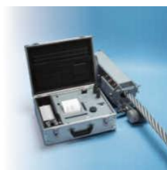
Фиг. 4. Meraster MD120 дефектограф за стоманени въжета - сензорна глава и инструмент за обработване и записване на сигнала
