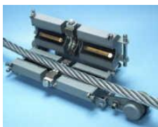
Фиг. 3. GP-серии сензорна глава
